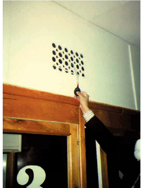
Tubo de humo para vigilar el flujo de aire en la cabina de recogida de esputo en un establecimiento de tuberculosis en Riga, Letonia
